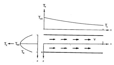
Fig. 18. Temperaturverteilung in einer fliessenden Schmelze.
