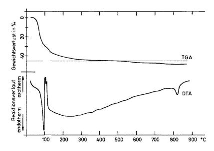
Fig. 2. Thermogravimetrische und DTA-Kurve der Probe AJ-1.
