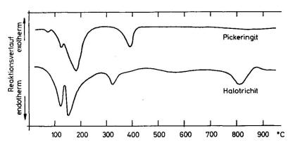
Fig. 1. DTA-Kurven für Pickeringit und Halotrichit nach G. Cocco (1952).
