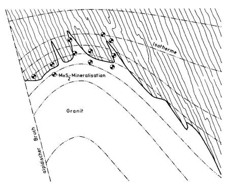
Fig. 8. Skizze zur Deutung der lokalen Anreicherung der MoS<sub>2</sub>-Mineralisationen im Bereich der obersten Aufstülpung der Grisighorn-Granitzunge.
