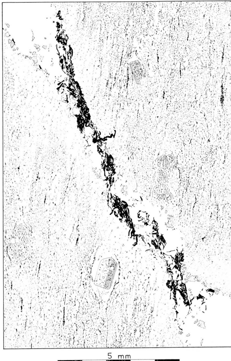
Fig. 1. Dünnschliffbild eines Mikroklin führenden Molybdänglanz-Quarzganges, welcher einen postzentralaaregranitischen Quarzporphyr durchschlägt. Eine alpidische Schieferung ( S_1 ) hat den Gang und das Nebengestein überprägt.
