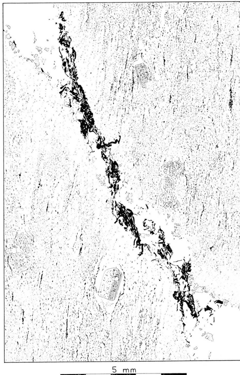
Fig. 1. Dünnschliffbild eines Mikroklin führenden Molybdänglanz-Quarzganges, welcher einen postzentraalaregranitischen Quarzporphyr durchschlägt. Eine alpidische Schieferung ( S_1 ) hat den Gang und das Nebengestein überprägt.
