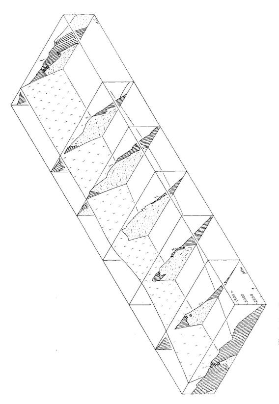
Fig. 6. Das Stereogramm zeigt die räumliche Verteilung der Molybdänglanz-Mineralisationen in 7 Kulissenprofilen quer durch den 18 km langen Grisighorn-Granitzug (Zentraler Aaregranit).
