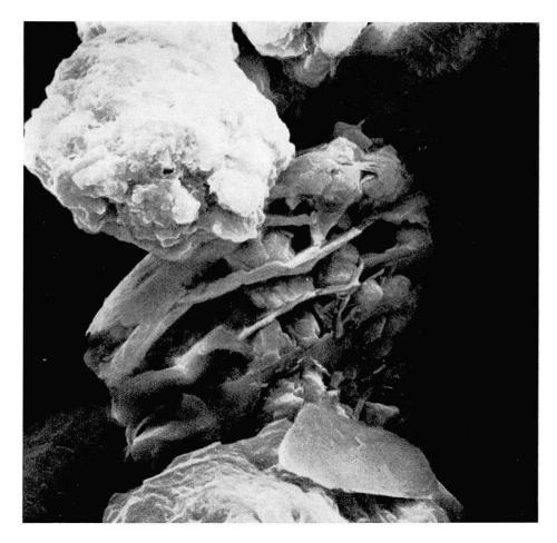
Fig. 6.  $30-40~\mu$  grosses Aggregat des Opalinustons. Raster-Elektronenmikroskop, 2000 fach.
