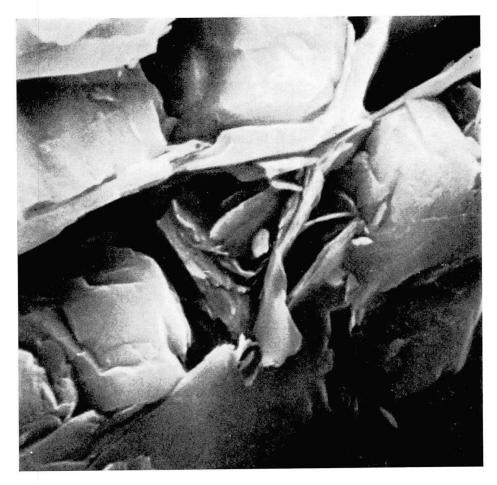
Fig. 7. Ausschnitt des Opalinuston-Aggregates. Raster-Elektronenmikroskop, 10000 fach.
