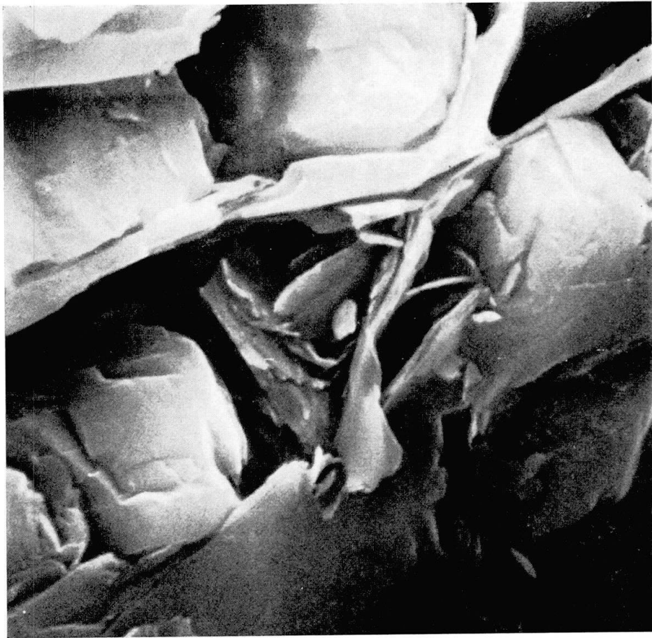
Fig. 7. Ausschnitt des Opalinuston-Aggregates. Raster-Elektronenmikroskop, 10 000fach.
