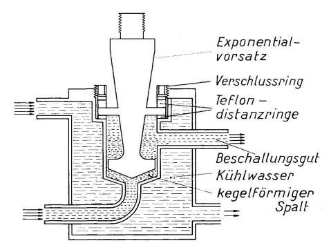
Fig. 1. Durchlauf beschallungskammer, Massstab 1:2.
