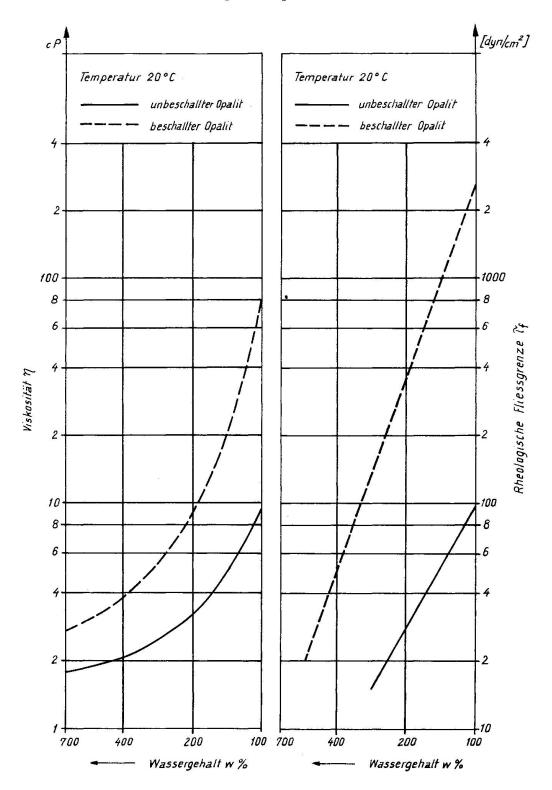
Fig. 4. Rheologische Fliessgrenze und Viskosität unbeschallter und beschallter Opalit-Suspensionen nach Bestimmung mit dem Kapillarviskosimeter.
