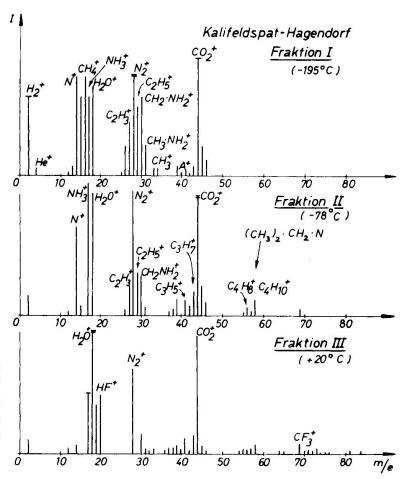
Fig. 2. Massenspektren der aus einem Hagendorfer Feldspat extrahierten Gase. (Kaltextraktion durch Mahlen unter Vakuum, Gasfraktionierung durch Ausfrieren. T= Ionenstrom·10; = Ionenstrom·100).
