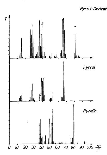
Fig. 3. Massenspektren N-haltiger Heterocyclen.
