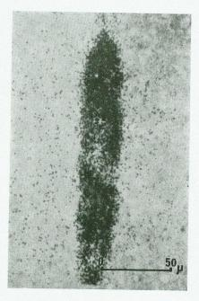
Fig. 8. Balayage à la sonde électronique raie  $K_{\alpha}$  Zr. Le pointillé noir dense correspond à la distribution du zirconium, la matrice quartzeuse est en grisé.
