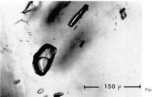
Fig. 1 et 2. Inclusions à hydrocarbures liquéfiés (température de la préparation:  $+20^{\circ}$  environ). Au chauffage, à des températures comprises entre  $+34^{\circ}$  et  $+37^{\circ}$ , on observe la disparition progressive du ménisque séparant gaz et liquide et le passage à l'état hypercritique.
