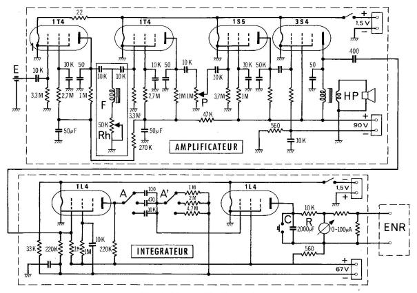
Fig. 2. L'ensemble électronique.
