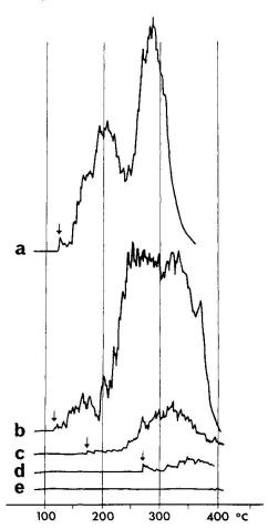
Fig. 3. Décrépitogrammes. a: barytine; b: fluorine; c: quartz; d: blende; e: galène.
