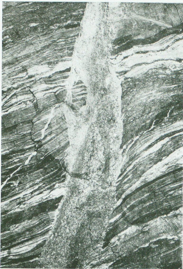
Photo 4b. Das Ganze wird von einem jüngeren Aplitgang diskordant durchsetzt (Weststoss). Zu- leitungsstollen, unterer Teil, m 512.
