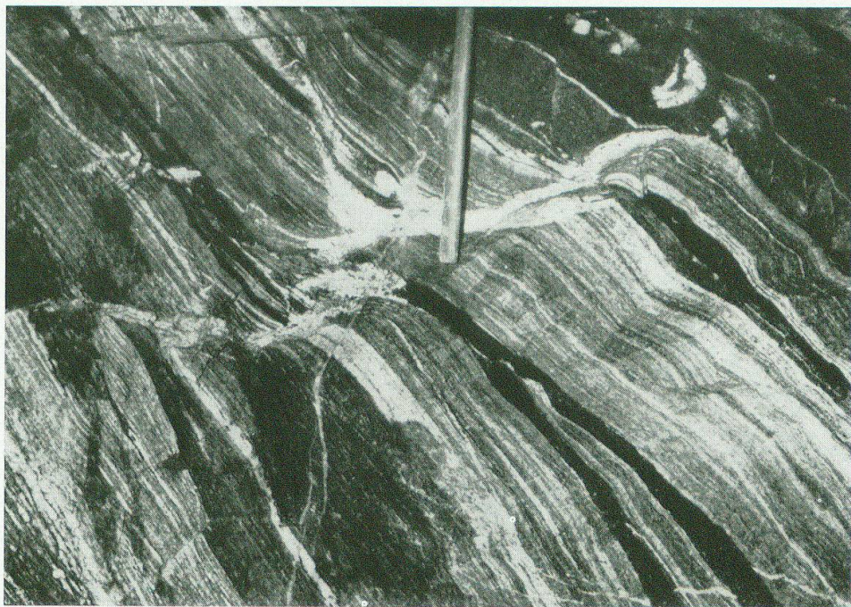
Photo 3. Synmigmatisch aufgerissene und mit Neosom gefüllte Zerrspalte in gebändertem Amphibolit. Zuleitungsstollen, oberer Teil, m 498.
