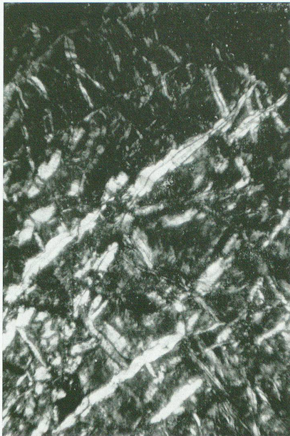
Photo 5. Serpentine massive, entre nicols croisés. Gross. 42 \times . On remarque le dédoublement des veinules de chrysotile \alpha .
