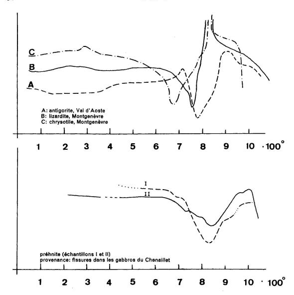
Fig. 2. Diagramme d'analyse thermique différentielle.
