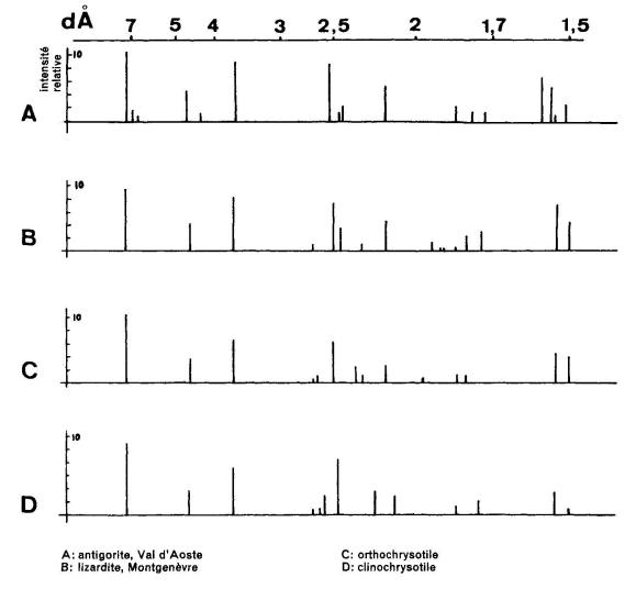
Fig. 3. Diagrammes de diffraction x = (Caméra de Guinier, Fe, air).
