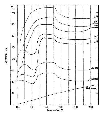
Fig. 6. Dilatometerkurven von Tonproben, Ziegel- und Steinmischungen aus der Tongrube Allschwil. Aufheizgeschwindigkeit 5° C pro Minute.
