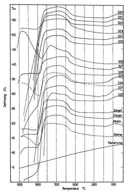
Fig. 8. Dilatometerkurven von Tonproben, Ziegel- und Steinmischung der Tongrube Rapperswil. Aufheizgeschwindigkeit 5° C pro Minute.
