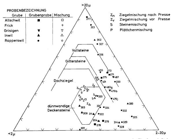
Fig. 5. Winkler-Diagramm mit den untersuchten Gesteinsproben sowie Ziegel- und Steinmischungen
