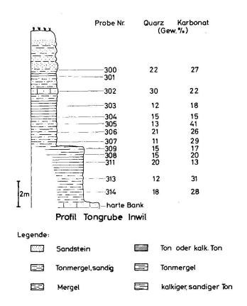
Fig. 3. Schematisches Profil der Tongrube nördlich Inwil.
