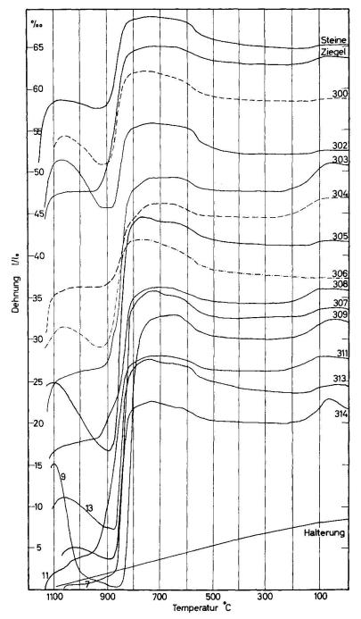
Fig. 7. Dilatometerkurven von Tonproben, Ziegel- und Steinmischungen der Tongrube Inwil. Aufheizgeschwindigkeit 5° C pro Minute.
