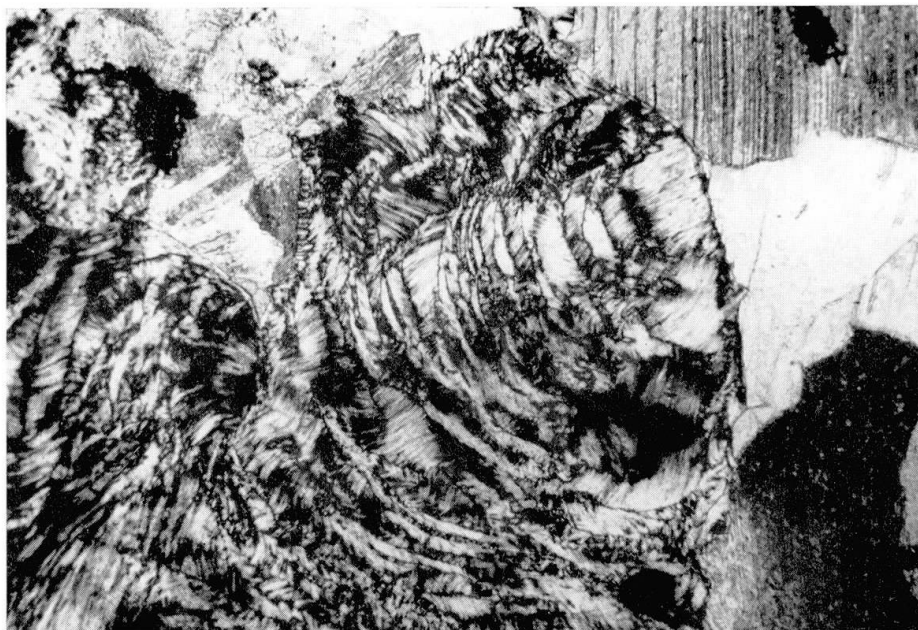
Fig. 2. Konzentrische Deformationsbänder in Brucit. Rechts (hell) ein Dolomittkorn, oberhalb und unterhalb davon Calcit. + Nicols 28\times .
