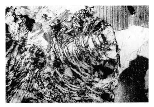
Fig. 2. Konzentrische Deformationsbänder in Brucit. Rechts (hell) ein Dolomitkorn, oberhalb und unterhalb davon Calcit. + Nicols  $28 \times$ .
