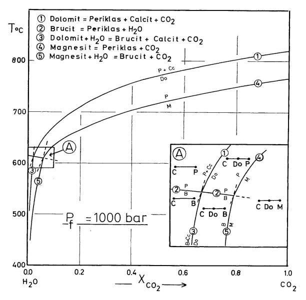
Fig. 1. Gleichgewichtsbeziehungen im System CaO-MgO-CO<sub>2</sub>-H<sub>2</sub>O, zusammengestellt nach experimentellen und berechneten Daten (vgl. Fussnote 1). Reaktion (1) nach Metz (1968). Fehlerbereiche der Kurven: bis  $\pm 20^{\circ}$ .
