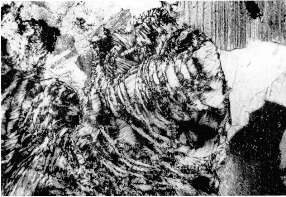
Fig. 2. Konzentrische Deformationsbänder in Brucit. Rechts (hell) ein Dolomitmikorn, oberhalb und unterhalb davon Calcit. + Nicols 28\times .
