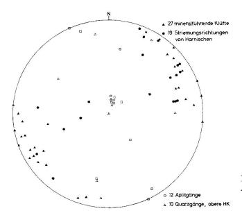
Fig. 30. Mineralklüfte, Harnischstreifen, Aplit- und Quarzgänge in stereographischer Projektion.
