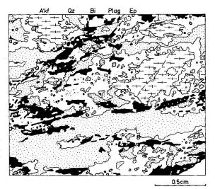
Fig. 4<sup>2</sup>). Granoblastischer Augengneiss mit Kornzeilenbau (ac-Schnitt). Rechts im Bild ist ein nach Karlsbader Gesetz verzwillingter Mikroklin zu sehen.
