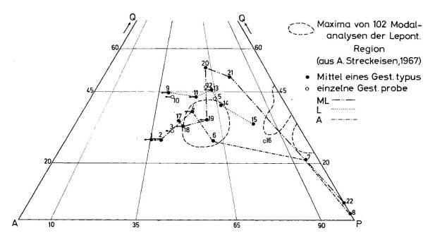
Fig. 20. QAP-Diagramm. Es sind die Mittel von Modalanalysen wichtiger Gesteinstypen der drei Kristallinkörper A, L und ML dargestellt (schwarze Punkte) sowie 5 Einzelproben aus A und L (Kreise), von denen je eine chemische Analyse vorliegt.
