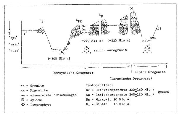
Fig. 7. Bathymetrisches Schema der Lebendun-Serie. Auf der Ordinate sind die vermuteten Metamorphosebedingungen aufgetragen, während auf der Abszisse der Sedimentations- und Deformationszyklus L<sub>B</sub>-L<sub>M</sub> dargestellt ist. (Altersbestimmungen durch E. Jäger, Bern.)
