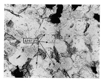
Photo  $n^0$  6. Apatite aciculaire avec un canalicule allongé selon l'axe sénaire; enclave microgrenue plagioclasique; L.N.,  $\times$  45. Echantillon  $n^0$  3.
