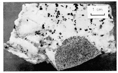
Photo  $n^0$  1. Enclave microgrenue plagioclasique de forme ovoïde, présentant un contact net avec le granite. Echantillon  $n^0$  1.
