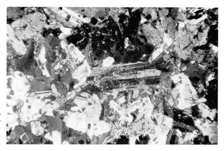
Photo  $n^0$  5. Structure poecilitique; enclave microgrenue plagioclasique; L.P.,  $\times$  13. Echantillon  $n^0$  3.
