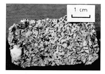
Photo nº 4. Lattes de micas visibles à l'œil nu dans une enclave microgrenue plagioclasique. Echantillon nº 6.
