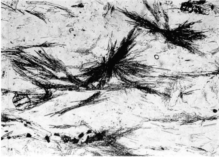
Fig. 4. Garbenförmige Aggregate von Stilpnomelan. Körner von Apatit am linken Rand und in der rechten oberen Ecke. Stilpnomelanschiefer Nr. 90, 1 km W Pongrácz-Pass. Vergr. 150 \times .
