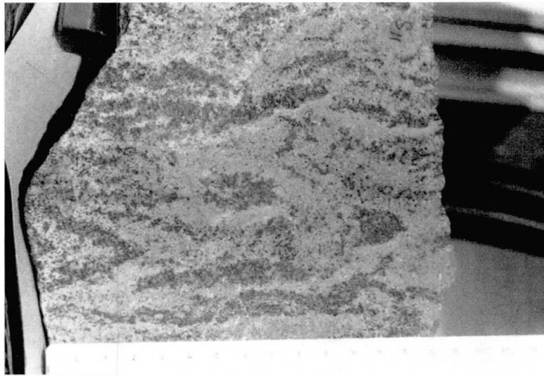
Fig. a) Echantillon S 11 . Stade très avancé du développement de la structure axiale tectonique, avec réorientation presque totale du matériel, et disparition de la foliation primaire. Noter la géométrie particulière de la tête de pli isolée.
