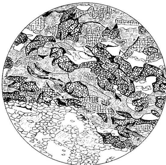
Fig. 9. Camp. Q 272. Scisto sericitico con relitti. Alpe del Vecchio. Granato in resti (a punteggiatura pesante). Epidoto (punteggiatura leggera fitta). Clorite (punteggiatura leggera rada), sericite in laminette, albite (con sfaldature), quarzo. Disegno originale. 30 ×.
