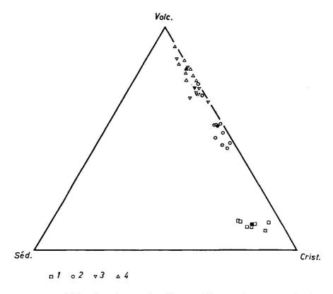
Fig. 4. Teneur en matériel volcanique, cristallin et sédimentaire: 1 = grès du val d'Illiez, 2 = Grès de Taveyanne pauvre en matériel volcanique, 3 = grauwackes des barres de l'Arbaron et de Tête Pelouse, 4 = grauwackes de la série de Gers, partie supérieure. Les valeurs moyennes sont indiquées par un signe plein.
