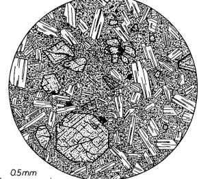
Fig. 11. Andésite à augite. Phénocristaux d'augite et de labrador à tendance microlitique. Pâte à structure hyalopilitique grossière ("serial-porphyrisch" des auteurs allemands). Localité: Combe Vernant, série de Gers, coupe No 621.
