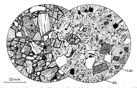
Fig. 12. Grauwacke à laumontite. Masse de fond chloriteuse (fig. de gauche): Plagioclase calcique remplacé par de l'albite limpide; les éléments détritiques (débris de plagioclases, d'augite, de hornblende, de quartz) sont bien visibles. La chlorite envahit le ciment et les fragments volcaniques.
