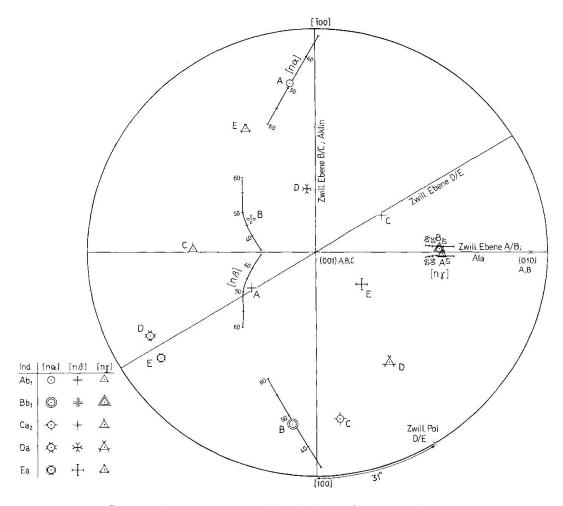
Fig. 5. Stereogramm auf (001) des Feldspates Nr. 11.
