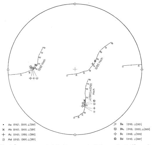
Fig. 2. Stereogramm  $\perp$  [n<sub> $\beta$ </sub>]. Basizitätszonen des Feldspates Nr. 14 (Akureyri).
