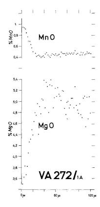
Fig. 2. Détail du bord gauche de la fig. 1, pour MnO et MgO, réalisé avec un intervalle de 2 microns entre chaque pointé.
