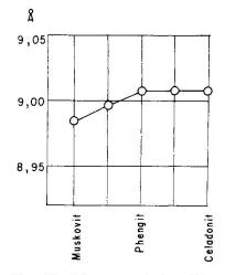
Fig. 19a. Beziehung zwischen Phengitgehalt und Gitterparameter b. Umgezeichnet nach Crowley und Roy, 1964.
