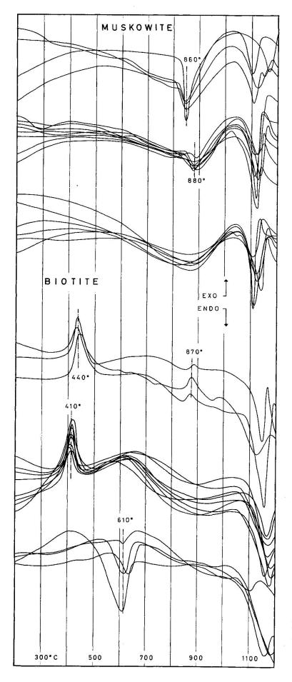
Fig. 7. Differential - Thermoanalyse einiger Muskowite und Biotite.
