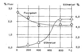
Fig. 1. Glüh- und Fluorgehaltsverlust des Lepidolitstandards NBS 183.
