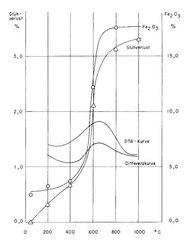
Fig. 8. Der Zusammenhang zwischen exothermer Eisenoxydation (FeO-Fe<sub>2</sub>O<sub>3</sub>), endothermem Glühverlust und der DTA-Aufnahme. Die Differenz des exound des endothermen Vorganges ergibt die "Differenzkurve" (relativer Massstab).
