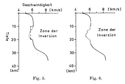
Fig. 5. Wahrscheinliche, prinzipielle Form der Geschwindigkeit-Tiefen-Funktion innerhalb der Inversionszone (punktiert). Im oberen Bereich dürfte die Geschwindigkeit nicht so stark abnehmen wie sie im unteren zunimmt.
