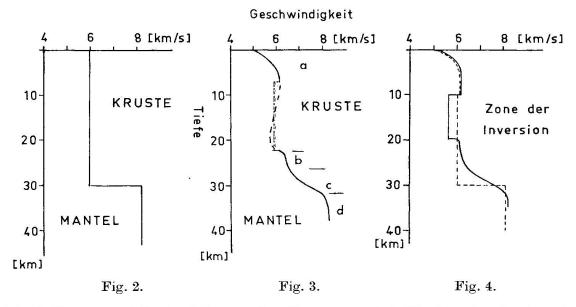
Fig. 2. Krustenmodell, abgeleitet aus den Kurven a und d (Fig. 1) unter der Annahme konstanter Schichtgeschwindigkeiten. Ein solches Modell muss als 1. Näherung angesehen werden. Es darf aber aus diesem Modell noch nicht der Schluss gezogen werden, dass zwischen Kruste und Mantel eine "scharfe" Grenzfläche vorhanden ist.
