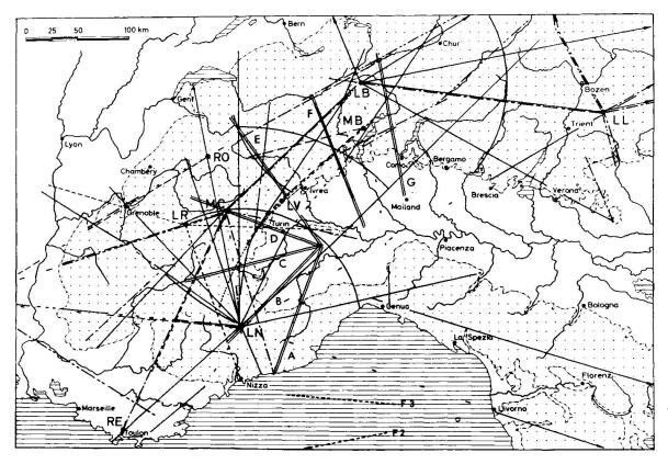
Fig. 8. Netz der Refraktionsprofile und der Fächer in den Westalpen. Sprengpunkte: LB: Lago Bianco, LL: Lago Lagorai, LN: Lac Nègre, LR: Lac Rond, LV: Levone (Bohrlöcher), MB: Monte Bavarione (Stollen), RE: Le Revest (Steinbruch), RO: Roselend (Steinbruch), F2 und F3: Refraktionsprofile im Ligurischen Meer (Fahlquist, 1963).
