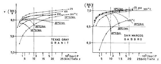
Fig. 10. Zusammenhang zwischen Geschwindigkeit und Druck (Tiefe) für eine Granitund eine Gabbro-Probe bei verschiedenen Temperaturen. Die Daten sind Arbeiten von Hughes und Maurette (1956 u. 1957) entnommen. Die gestrichelten Linien stellen die Geschwindigkeit-Tiefen-Funktion bei Annahme bestimmter Temperaturgradienten dar. Wenn auch hier Gesteine bestimmter Lokalitäten gewählt wurden, so ist doch die prinzipielle Form der Kurven für andere Gesteine ebenfalls die gleiche.
