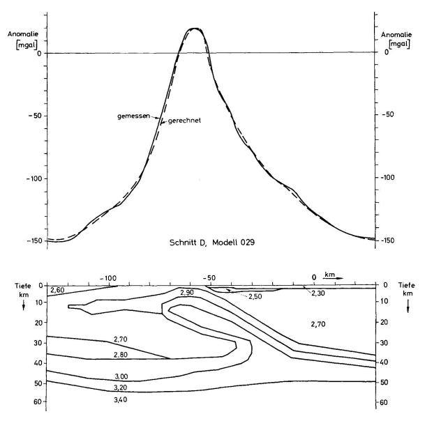
Fig. 1. Krustenschnitt D durch die Ivrea-Struktur mit gemessener und berechneter Bouguer-Anomalie. Die Zahlenwerte in dem Profilschnitt geben die Dichten in g/cm³ an. Crustal section through the structure of Ivrea. Solid curve is the computed total attraction for a cross section with the given density distribution in gm/cc compared with the observed anomaly (dashed line).
