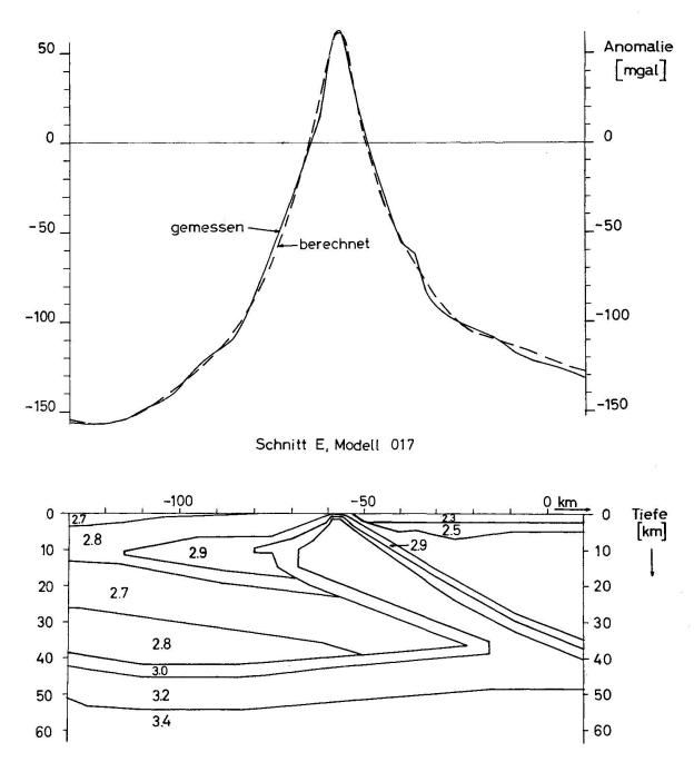
Fig. 2. Krustenschnitt E durch die Ivrea-Struktur mit gemessener und berechneter Bouguer-Anomalie. Die Zahlenwerte im Profilschnitt geben die Dichten in g/cm³ an. Crustal section E through the structure of Ivrea. Solid curve is the computed total attraction for a cross section with the given density distribution in gm/cc compared with the observed anomaly (dashed line).
