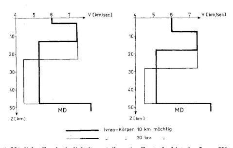
Fig. 5. Mögliche Geschwindigkeitsverteilung im Zentralgebiet des Ivrea-Körpers.
