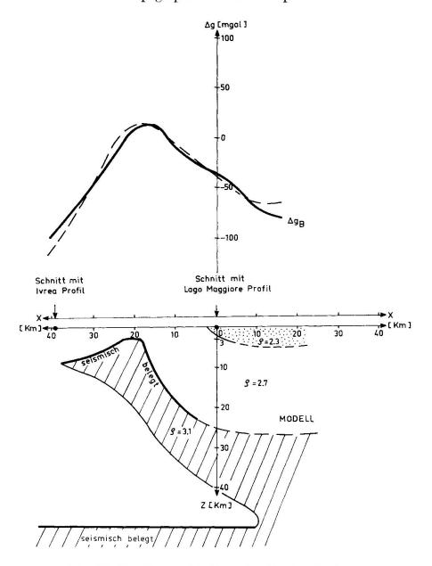
Fig. 11. Strukturmodell längs des 200-km-Fächers.
