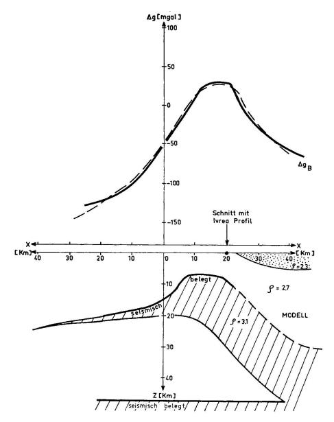
Fig. 7. Strukturmodell längs des 120-km-Fächers.
