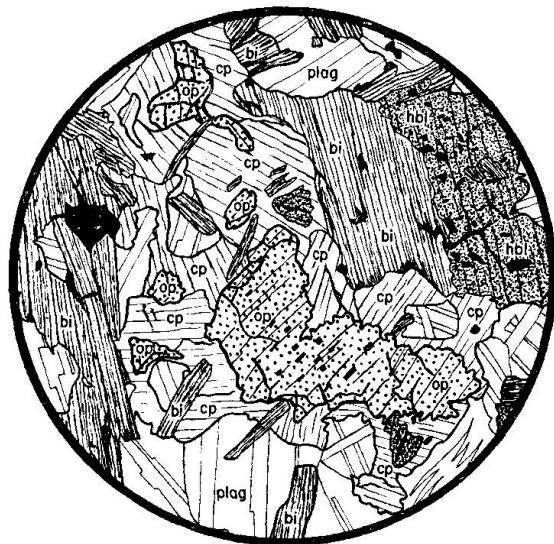
Fig. 3. Roccia biotitica senza K-feldspato (IV 110). Si osserva pirosseno rombico (op) in lembi residui entro pirosseno monoclino (cp) nel quale è parzialmente trasformato.
