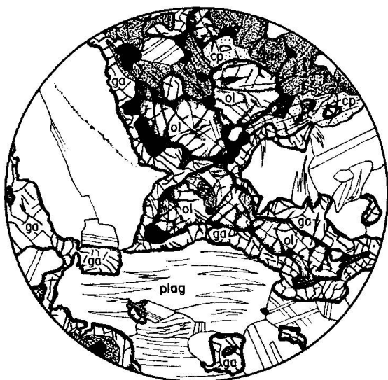
Fig. 1. Roccia senza K-feldspato (IV 36). Orli di granato (ga) che si originano per reazione tra olivina (ol) e plagioclasio (plag.).
