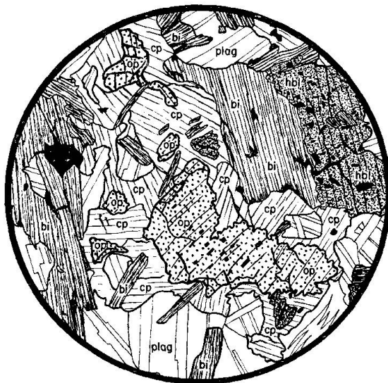
Fig. 3. Roccia biotitica senza K-feldspato (IV 110). Si osserva pirosseno rombico (op) in lembi residui entro pirosseno monoclinico (cp) nel quale è parzialmente trasformato.
