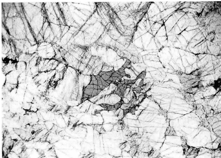
Fig. 3. Nicht metamorpher Lherzolite von Baldissero mit primärem, zwickelfüllendem Spinell. Bildlänge: 10 mm, Nic. //.
