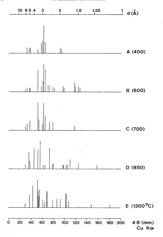
Fig. 3. Dati röntgenografici della brannerite di Lodrino riportati graficamente ("Strichdiagramme").
