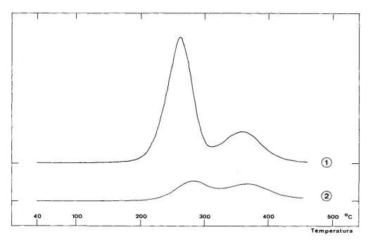
Fig. 9. Curve della termoluminescenza della calcite di Lodrino (curva 1) e del calcare di Pontis (curva di riferimento, no. 2). Per le spiegazioni efr. il testo.
