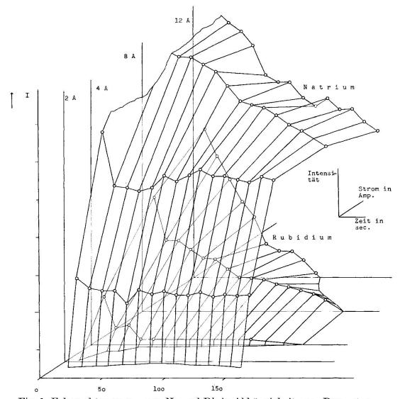
Fig. 1. Fahrspektrogramm von Na und Rb in Abhängigkeit vom Bogenstrom.
