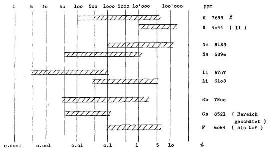
Fig. 2. Verwendungsbereich einzelner Spektrallinien bei gegebenen Abbrand- und Aufnahmebedingungen.
