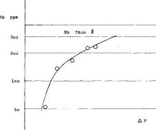
Fig. 5d. Eichkurve für das Element Rubidium.
