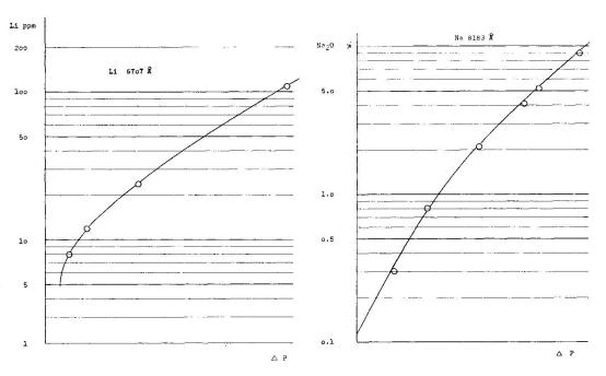
Fig. 5a. Eichkurve für das Element Lithium.
