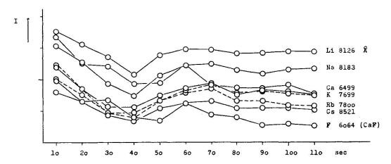
Fig. 3. Fahrspektrogramm der Elemente Li, Na, K, Rb, Cs und F, Ca bei Analysenbedingungen (vergl. Tab. 5).
