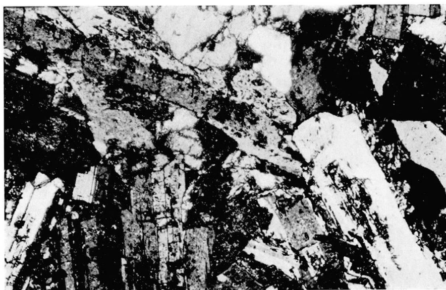
Photo 10. Ech. 471/1. Diorite augitique à structure interstitielle grossière. Gross. 50\times , L.P.
