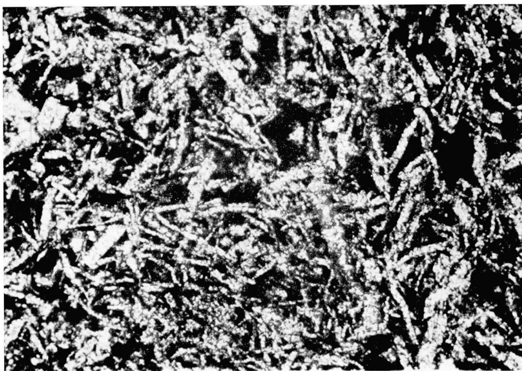
Photo 7. Ech. 692. Rodingite à pumpellyite. Gross. 100\times , L.N.
