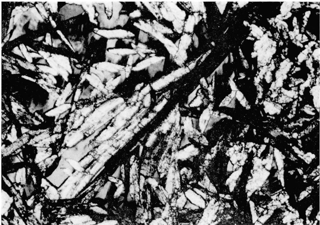
Photo 30. Cristaux de pumpellyite remplissant une veine dans une métadiabase. Gross. 100 \times , L.P.
