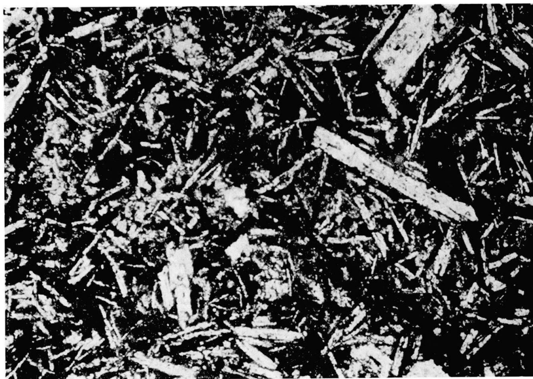
Photo 11. Ech. 131/62. Diorite albite-chloritique à structure interstitielle divergente. Gross. 100\times , L.N.
