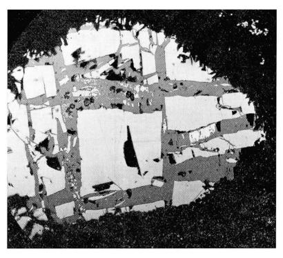
Fig. 1. Erztropfen mit vorwiegend kataklastischem Pentlandit, von Magnetit zementiert. In diesem liegen mehrere zackig begrenzte Gebilde von Awaruit (heller als Pentlandit). Randlich spiessen die Blätter der Serpentinmineralien in den Erztropfen.  $140 \times$ .
