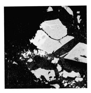
Fig. 3. Pentlandit (lichtgrau) wird von hellerem Heazlewoodit verdrängt. Der Magnetit ist hier fast schwarz. Öl,  $215\times$ .
