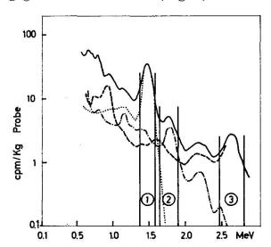
Fig. 3. Gammaspektrum einer pulverisierten Gesteinsprobe (nach Gustafson and Brar, 1964) mit Anteilen von U (—.—), Th (——) und K(.....) sowie mit den gewählten Kanalstellungen (1), (2), (3).
