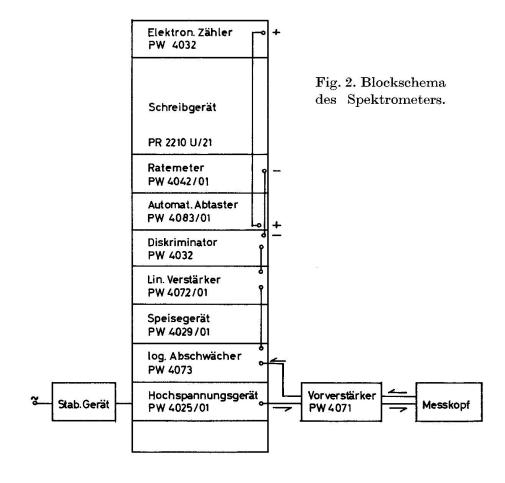
Die ganze Apparatur besteht aus 10 Einheiten, abgesehen vom Strahlungsdetektor und einem separaten Netzstrom-Stabilisiergerät (Fig. 2).
