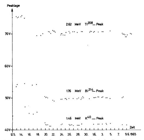
Fig. 4. Verschiebungen der Kanalstellungen im Laufe der Zeit (Hochspannung: 960 V, Abschwächung: 10<sup>1,8</sup>, 10<sup>0,18</sup>, 10<sup>0</sup>).
