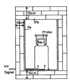
Fig. 1. Querschnitt durch das Abschirmungsgehäuse mit Messkopf.
