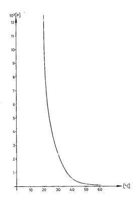
Fig. 2. Temperaturabhängigkeit der Viskosität  $\eta[P]$  bei Glucose (85% ig).
