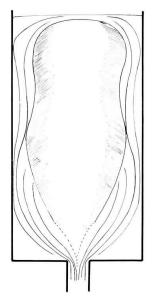
Fig. 32. Phänomene bei der Wechselwirkung zweier unterschiedlich viskoser Glucosen. Die weniger zähe, spezifisch leichtere Glucose ist im Begriff, als geschlossener Körper durch die spezifisch schwerere Glucose aufzusteigen. Es tritt zwar keine Vermischung auf: die "klebende" Grenze zwischen beiden Glucosen veranlasst aber die aufsteigende Glucose zur Ausbildung jener feinen Scherungsschlieren, die bereits S. 447 erwähnt waren.
