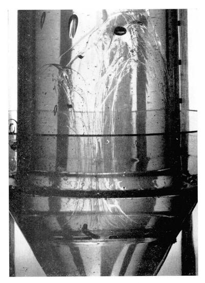
Fig. 28. Kanalisierung ansteigender Glucose durch ein sternförmiges Hindernis. Eine Plexiglasplatte mit drei radialen Streben (schwarz im Foto) sitzt senkrecht zur Strömung, konzentrisch im konischen Teil der Fliessstrecke. Oberhalb des Hindernisses entwickeln sich drei Schlierenkuppeln nebeneinander. Dort wo sich die drei Kuppeln aneinanderfügen, also längs der Mittelachse des Zylinders, bildet sich ein Kanal, in welchem Teilchen fliesslinienparallel ausgerichtet werden.
