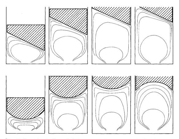
Fig. 15. Form der Quellkuppeln bei unterschiedlich profilierter Decke. Es passen sich die Kuppeln sehr genau dem schräg auflastenden oder konvex bzw. konkav geformten Deckel an. Im weiteren Abstand vom Deckel sind aber Quell- und Steigkuppeln ungestört entwickelt.
