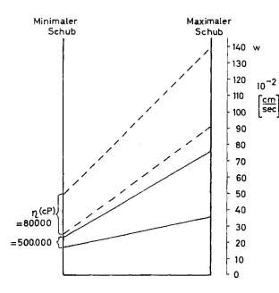
Fig. 8. Geschwindigkeitsverhältnisse zwischen Flüssigkeitsanstieg und Teilchenanstieg ( $\cong w_{max}$  des Geschwindigkeitsprofils) in der Einweganlage, demonstriert an zwei unterschiedlich viskosen Glucosen. Auf der linken Ordinate sind die Geschwindigkeiten bei minimalem Hub, auf der rechten Ordinate die bei maximalem Hub eingetragen.
