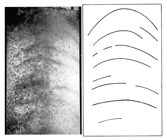
Fig. 40. Grobe Quellkuppeln an Gelatine-Gel (vor Eintritt in den Zylinder rhythmisch mit Neococcin gefärbt). Das Gel ist durch das Vorpressen in der Leitung und durch den Quellvorgang beim Eintritt in den Zylinder zerkrümelt. Der viskoelastische Stoff wird so zum Zweiphasensystem (wässrige Suspension) und ähnelt im Fliessverhalten dem der reinviskosen Flüssigkeiten. Daher nimmt auch mit wachsendem Abstand vom Quellbereich die Kuppelkrümmung zu.
