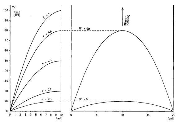
Fig. 10. Geschwindigkeitsprofile für Rohrströmungen (Rohrdurchmesser 2r = 20 cm) und mittlere Geschwindigkeiten  $\overline{w}$  von 5 bis 50 cm/sec.
