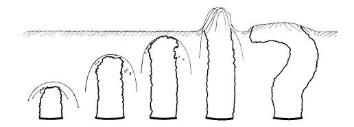
Fig. 38. Extrusionspfropfen einer Reiskorn-Glucose-Suspension, die beim Vorschub in der Leitung zu einer kohärenten Paste immobilisiert wurde. Die Masse dringt aus der Bodenplatte in den mit Glucose gefüllten Zylinder, steigt senkrecht an, bei weiterem Fliessen sogar über das Flüssigkeitsniveau der Glucose im Zylinder hinaus, verbiegt schliesslich infolge ihres eigenen Gewichtes und sinkt in die Glucose zurück.
