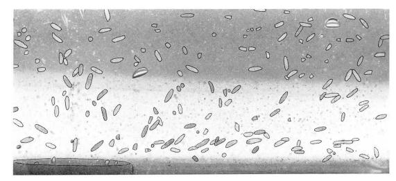
Fig. 45. Einströmversuch von Glucose in die lange Wanne. Ausschnitt aus dem Bereich der Zufuhröffnung. Die Längsachsen der Reiskörner liegen ± parallel der Seitenwand (Bildebene). Die Rotation der Reiskörner in der Ebene parallel der langen Wand (Bildebene) hängt von lokalen Wickelfalten ab.
