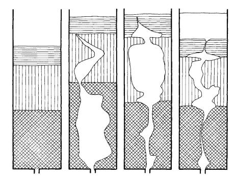
Fig. 35. "Intrusionsversuch." Eindrücken einer geringer viskosen Glucose durch Schichten höher viskoser (und damit auch spez. schwererer) Glucosen. Die Intrusionsmasse durchwandert unter Aufbeulung und Abschnürung die einzelnen Schichten.
