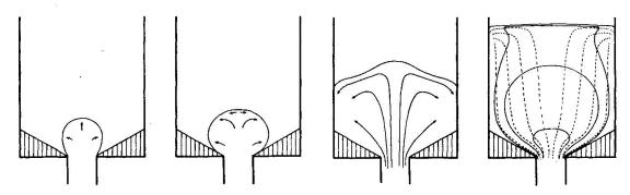
Fig. 14. Einwegversuch im Stadium des Ineinandergreifens von Quellbereich und Scheitelgleitungsbereich. Eine eigentliche Steigstrecke hat sich nicht ausgebildet, die Fliesslinien (punktiert in der rechten Zeichnung) verlaufen nicht rohrparallel. Typischer Strömungsendzustand von Granitplutonen. Sichtbarmachung der Effekte im Versuch wie im geologischen Körper durch Schlierenbildung und Regelung anisometrischer Festkörper.
