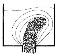
Fig. 39. Strömungsparallele Anordnung der Reiskörner bei der Extrusion der immobilisierten Reiskorn-Glucose-Suspension (siehe Fig. 38).
