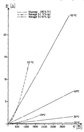
Fig. 3. Fliesskurven für zwei Rohagit-Lösungen (5% ig und 10% ig) im Vergleich zur (reinviskosen) Glucose.
