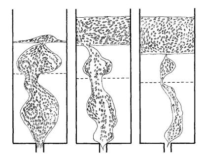
Fig. 36. Teilchenregelung beim Intrusionsversuch. Bild links: Stadium der Entleerung der unteren Beule in die obere Schicht. Infolge des relativ langsamen Eindrückens ist die untere Beule noch nicht ganz entleert, obwohl sich die obere Beule bereits auf die Oberfläche zu ergiessen beginnt (mittleres Bild). Bild rechts: Endstadium der Intrusion. Die internen Bewegungen der Flüssigkeit — kenntlich durch die Verdriftung der Reiskörner — sind durch Pfeile gekennzeichnet.
