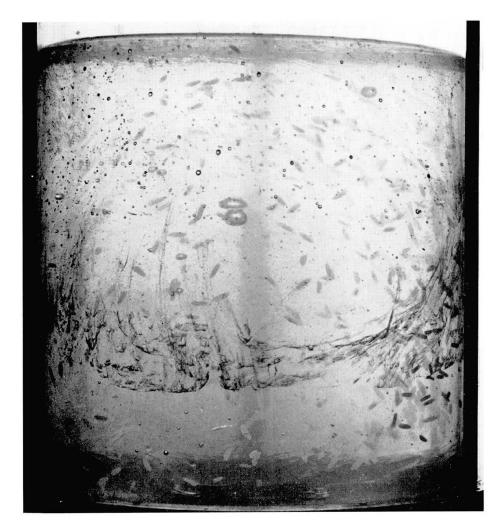
Fig. 21. Modell der Regelung in einem annähernd isometrisch gebauten Pluton: Planare Anordnung der Reiskörner in Quellkuppeln; zusätzliche Gleiteffekte vom Scheitel gegen die Peripherie. Die Scheitelgleitung ist hier sichtbar gemacht durch angelöstes Neucoccin-Pulver, dessen scheinbarer Abstieg an den Wänden bedingt ist durch das zentrale Ansteigen der quellenden Masse.
