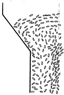
Fig. 19. Übergang vom Rohr in den Zylinder, beobachtet im gläsernen Stutzen. Gezeichnet ist das halbe Profil. Man erkennt Anreicherung der Körner im zentralen Teil des Rohres; ebenso ist die Tendenz der Teilchen deutlich, sich am Rande mehr oder weniger senkrecht zur Rohrwand zu stellen. Zwischen Mitte und Rand rotieren die Teilchen im Stutzen, bei Betonung fliesslinienparalleler Ausrichtung. Beim Eintritt in den Konus wird diese Anordnung umgebaut in die Kuppelstruktur.
