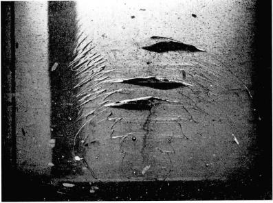
Fig. 33. Eindringen von geringer viskoser in höher viskose Glucose. Die Intrusionsmasse durchstösst hier nicht den zäheren Körper, sondern drängt, dem Kuppelbau des Wirtes nachfahrend, zur Seite und zwängt sich zwischen die einzelnen Kuppelschalen. Solche verzahnten Strukturen finden sich auch in geologischen Körpern.
