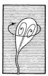
Fig. 37. Kopf einer unter hohem Druck in hochviskose Glucose eingepressten Gelatine-Reiskorn-Suspension. Die schnelle Platznahme der Suspension führt zu inneren und äusseren wirbelnden Bewegungen des "Phantoms".
