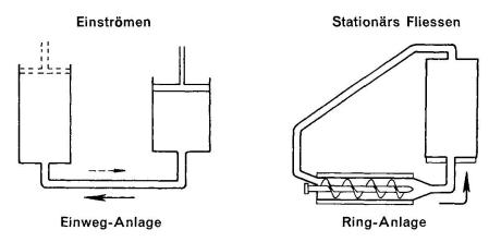
Fig. 4. Schema der Versuchsanordnung an der Einweg- und Ringanlage. Der hydraulisch betriebene Kolben (rechts) der Einweganlage erzeugt die Flüssigkeitsbewegung. Nach dem Versuch drückt ein Hilfskolben die Flüssigkeit aus dem Beobachtungskolben in die Ausgangsposition zurück. Bei der Ringanlage erfolgt der Antrieb durch eine Schnecke, vgl. Fig. 5. Hier kann die Fliessrichtung durch Umkehren der Schraubendrehung geändert werden.
