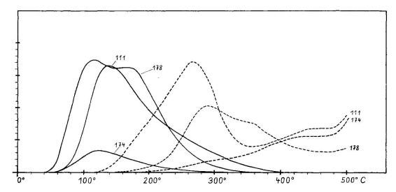
Fig. 2. Die Glow-Kurven der natürlichen und durch Röntgenstrahlung erzeugten Thermolumineszenz am Beispiel des Albites von Portland (Nr. 178) und der Oligoklase von Bakersville (Nr. 111) und Hemet (Nr. 174). Die Intensitäten der natürlichen Thermolumineszenz verhalten sich zur künstlichen bei den Proben Nr. 111 und 174 wie 1:500, bei 178 wie 1:200.
