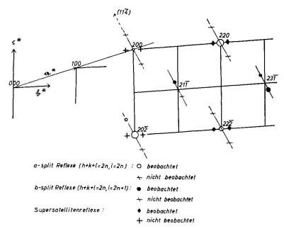
Fig. 2. Schematische Darstellung der Satellitenreflexe des Labradorits ( $52 \, \text{Mol-} \% \, \text{An}$ ). Der Abstand der Supersatellitenreflexe zu den Hauptreflexen ist stark vergrössert.
