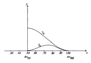
Fig. 7. Die theoretischen Intensitäten der a- und b-split-Reflexe der Plagioklase An<sub>c</sub>Ab<sub>1-c</sub> (vgl. Fig. 5 und 6).
