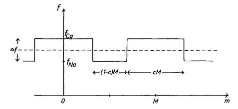
Fig. 5. Ein Modell der Dichte-Welle in der a- und b-split erzeugenden Überstruktur des Labradorits. An<sub>c</sub>Ab<sub>1-c</sub>.
