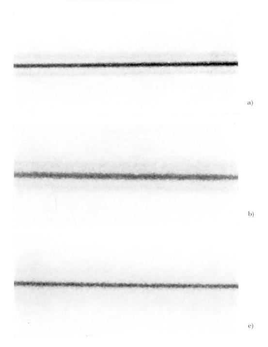
Fig. 3. Haupt- und Supersatellitenreflexe an (220) dreier verschiedener Labradorite: a) mit violettem Schiller  $An_{52}$ , b) mit UV-Schiller, c) ohne Schiller,  $An_{53}$  und  $Or_{1,7}$ . Optische Nachvergrösserung: 20 fach.
