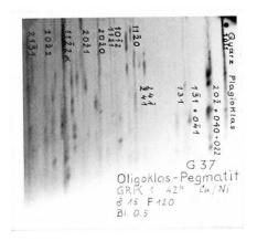
Fig. 3. Übersichtsdiagramm von Oligoklas-Pegmatit G 37 (Nr. 6, Tab. 1, Fig. 1) mit Indizierung der wichtigsten Quarzund Plagioklaslinien. Deutliche Regelung von Quarz und Plagioklas erkennbar.
