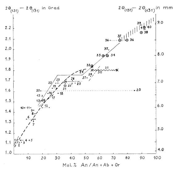
Fig. 1. Beziehung zwischen  $2 \theta_{(131)}$ — $2 \theta_{(\bar{131})}$  (Cu/Ni-Strahlung) und chemischer Zusammensetzung der Plagioklasgruppe. 1—40 untersuchte Proben (s. Tab. 2). Kurven  $2 \theta_{(131)}$ — $2 \theta_{(\bar{131})}$  / An-Gehalt.
