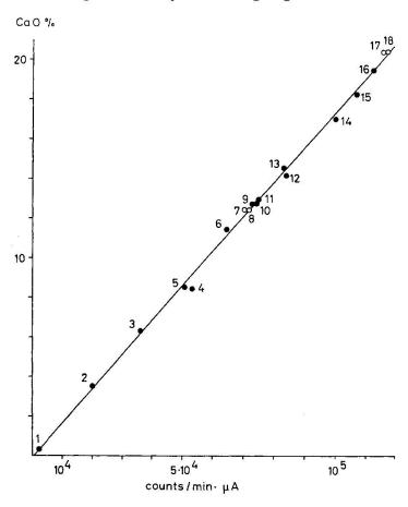
Fig. 2. Eichkurve zur Bestimmung des CaO-Gehaltes in Plagioklasen (An 0 bis 100). Messbedingungen: Ca $K_{\alpha}$ 60° 06′ (Quarz), Strahldurchmesser ca. 1 Mikron, Probenstrom 0,3  $\mu A$ , Beschleunigungsspannung 25 KV, Strahlstrom 50  $\mu A$ , Messdauer 1′. Nummern 1 bis 18 beziehen sich auf Tabelle 2.
