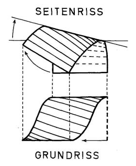
Fig. 2. Modellversuch zur Erklärung der Neuverformung des nördlichen Gewölbes. Ein bogenförmig gefaltetes Blatt mit parallel zur Gewölbeachse aufgezeichneten Lineationen ist durch drehende Bewegung des einen Schenkels derart verformt worden, dass die Lineationen schief, aber abwickelbar zur Gewölbeachse zu liegen kommen. Die Gewölbeachse hat ihre Lage in der Vertikalebene verändert. Das neuverformte Blatt ist im Seiten- und Grundriss gezeichnet.
