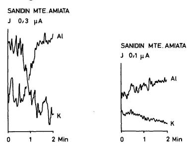
Fig. 1. Einwirkung des Elektronenstrahles auf die Probenoberfläche; Änderung der chemischen Zusammensetzung.
