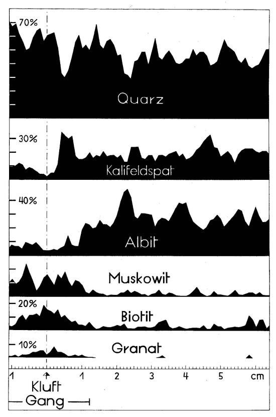
Fig. 8. Zonare Mineralverteilung im metasomatischen Erzgang SH 537 in der porphyrischen Randfacies des Zentralen Aaregranites. (Koordinaten 638.550/137.700/3020.)
