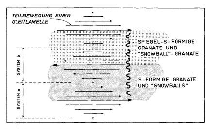
Fig. 7. Schematische Darstellung und Interpretation eines Dünnschliffbildes von Glimmerschiefer mit gedrehtem Granat (Schliffebene gleich ac-Schnitt).
