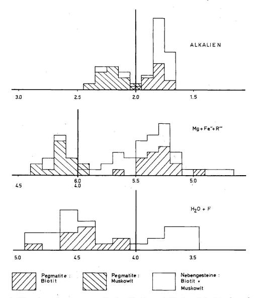
Fig. 9. Die Abweichungen vom idealen Biotit- und Muskowitstrukturformelwert. x-Achse: Formelwerte; idealer Wert durch dicken, vertikalen Strich gekennzeichnet. y-Achse: Häufigkeit der beobachteten Fälle.
