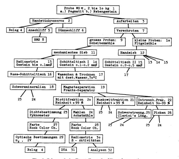
Fig. 6. Schematische Darstellung der Mineralseparation.
