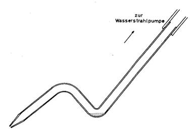
Fig. 8. Mineraliensauger zum Picken und Sortieren von Mineralkörnern.
