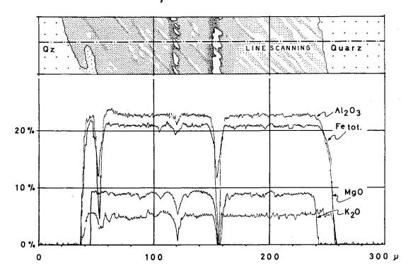
Fig. 17. Line Scanning mit der Elektronen-Mikrosonde über ein Biotitbuch der Probe WS  $\pi$  35a. Oben: Scanningspur auf der Probenoberfläche. Unten: Verteilung der Elemente Al<sub>2</sub>O<sub>3</sub>, Fe<sub>tot.</sub>, MgO, K<sub>2</sub>O.
