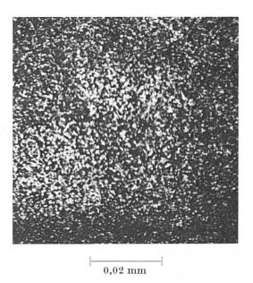
Fig. 4. Aufnahme an der Mikrosonde. Verteilung des Siliziums im gleichen Bereich wie Fig. 2 und 3.
