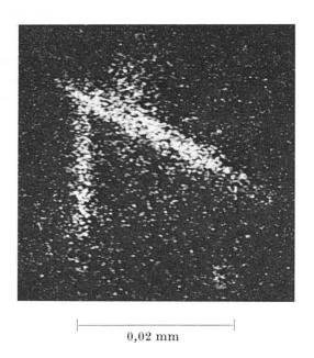
Fig. 6. Aufnahme an der Mikrosonde. Verteilung und Konzentration des Titans in den Sagenitnadeln.
