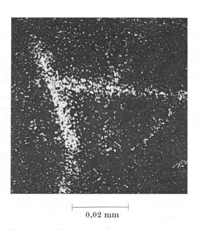
Fig. 2. Aufnahme an der Mikrosonde. Verteilung und Konzentration des Titans in den Sagenitnadeln.
