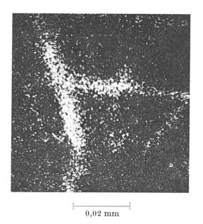
Fig. 3. Aufnahme an der Mikrosonde. Verteilung und Konzentration des Calciums in den Sagenitnadeln.
