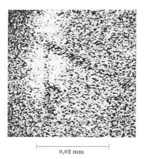
Fig. 8. Aufnahme an der Mikrosonde für das Silizium. Sagenitnadeln erkennbar. (Vergleiche Text und Tab. 2.)
