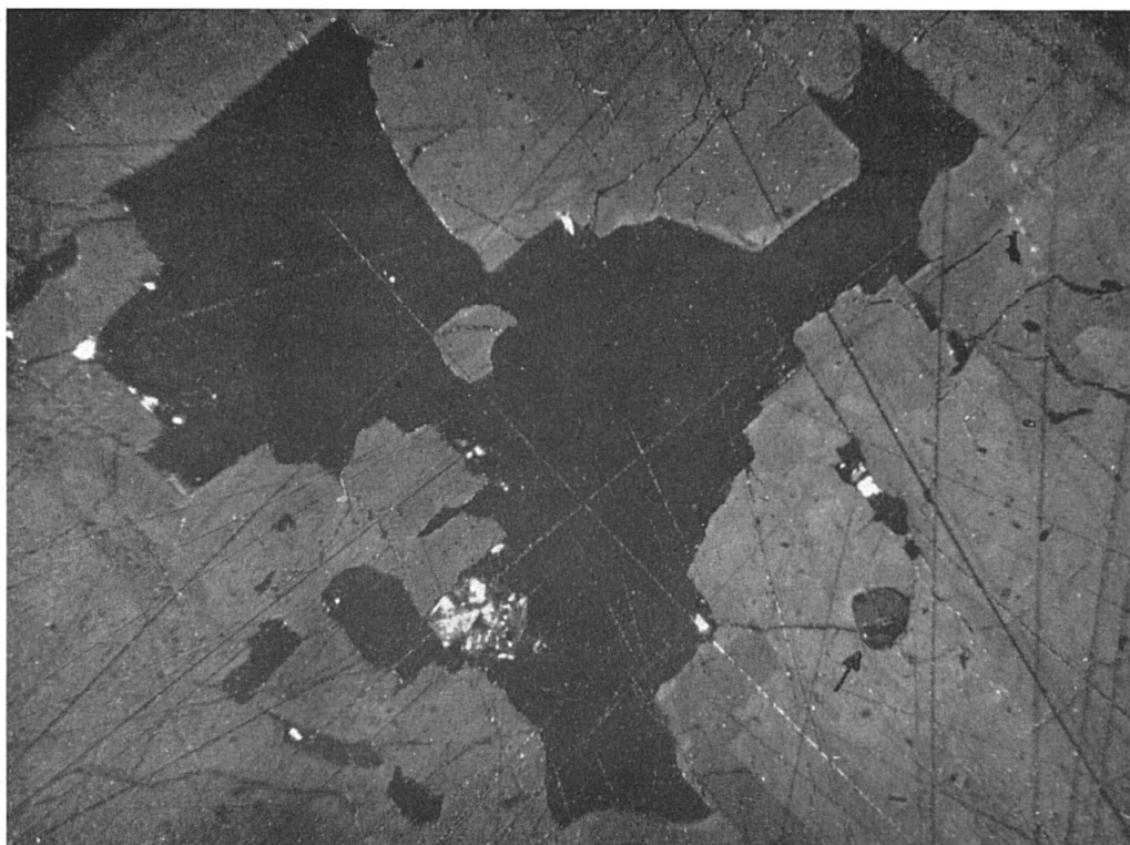
Fig. 28. Anschliff: Arsenkies vom Lengenbach (SG 698). Der Kern des Arsenkies-Kristalles wird durch Pyrit gebildet (dunkel), dessen korrosionsähnliche Form vermutlich auf Verdrängung durch Arsenkies zurückzuführen ist. Die inhomogene Beschaffenheit des Arsenkieses ist deutlich zu erkennen. Bei dem mit einem Pfeil markierten rundlichen Einschluss handelt es sich um ein Sulfosalz-Mineral. Gekreuzte Polarisatoren. Vergrößerung ca. 30\times .
