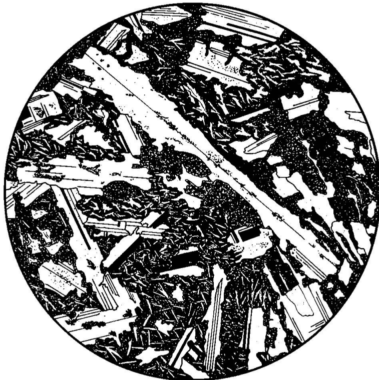
Fig. 19. Schéma de la structure intersertale divergente à pâte microlitique „pilotaxique“ (Jaunpass).
