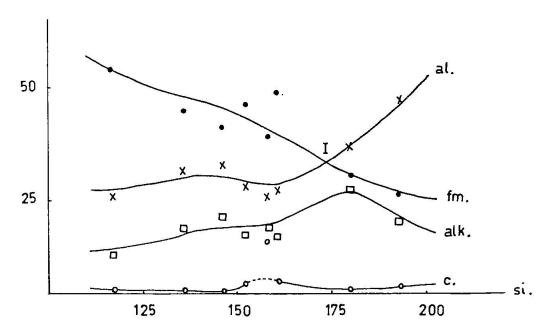
Fig. 26. Diagramme de variation des laves spilitiques des Préalpes romandes (variations de al, alk, fm et c en fonction de si).
