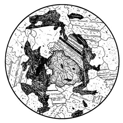
Fig. 23. Granite à albite, biotite et grenat du Jaunpass (R<sub>32/II</sub>).
