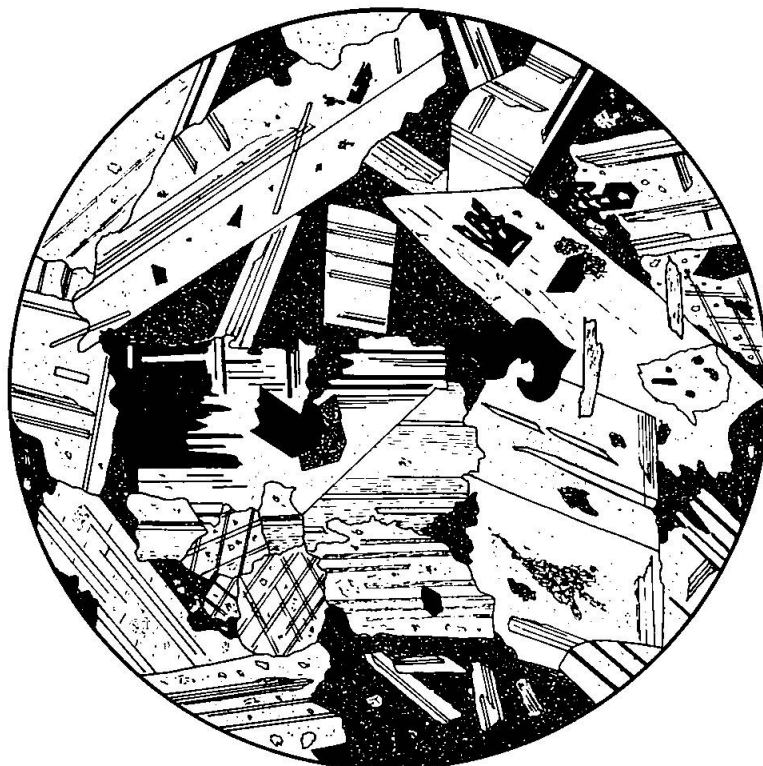
Fig. 17. Schéma de la structure intersertale (Jaunpass).
