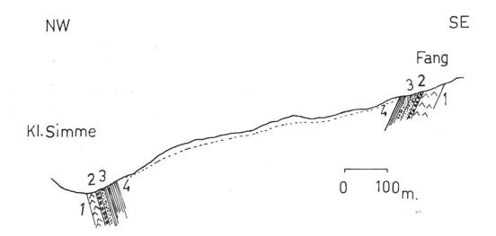
Fig. 8. Coupe schématique à travers les pointements de Fang et de la Kl. Simme montrant en position normale l'ensemble roche verte et brèche polygénique dans les schistes encaissants.
