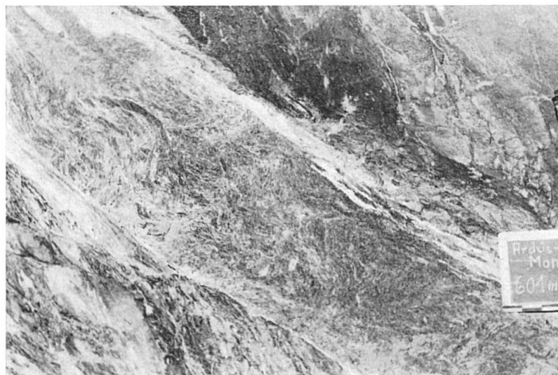
Fig. 8. Alpiner Mylonit in den Tuffen, auf der Oberseite starke, auf der Unterseite schwache Gipsausscheidungen. 601 m ab Stollenportal Ardüs.
