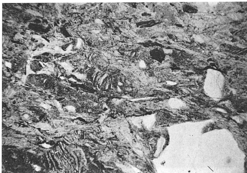
Fig. 3. Vergr. 25\times , Nicols II Kristall- Tuff, leicht myloni- tisiert. Handstück AL 587.
