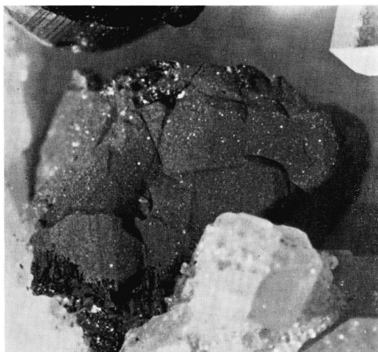
Fig. 4. Marrit mit Xanthokon, neben Pyrit mit Proustit; Vergrößerung ca. 7\times .
