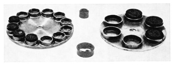
Fig. 1. Unterseite der Schleifplatten, mit Halterungen für die Bakelitringe versehen.
