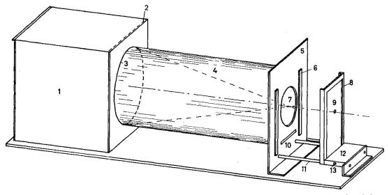
Fig. 1. Der Gefügediagrammauswerter. 1 = Lichtquelle mit Gehäuse, 2 = Opalglasscheibe, 3 = Eintrittsblende, 4 = Tubus, 5 = Vorderwand, 6 = Lochdiagrammhalter, 7 = Lochdiagramm, 8 = Kassettenhalter, 9 = Filmkassette mit Abdeckplatte, 10 = Eichschlitz, 11 = Führungsschiene, 12 = Führungsschlitten, 13 = Arretierschraube.
