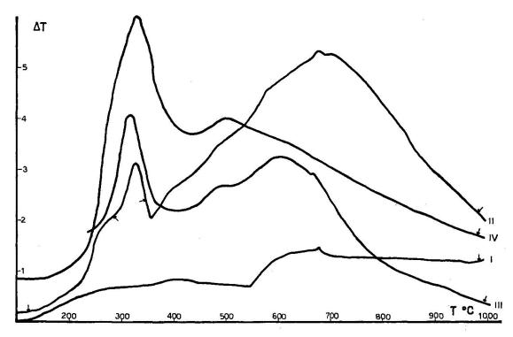
Fig. 1. DTA-Kurven von natürlichem Magnetit im  $O_2$ -Strom bei einer Aufheizgeschwindigkeit von  $10^{\circ}$  C/min. An den, mit einem Pfeil bezeichneten Stellen wurden Röntgenanalysen vorgenommen.
