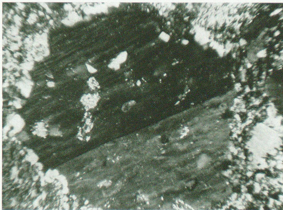
Photo n° 14. Plage de feldspath potassique maclé selon Carlsbad avec lamelles floues selon l'albite. Echantillon Roffna n° 10.
