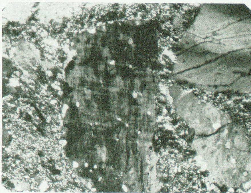
Photo n° 16. Gros fragment de feldspath potassique finement treillissé (macles de l'albite et de la péricline). Echantillon Roffna n° 11. G = 35 ×. Nicols croisés.
