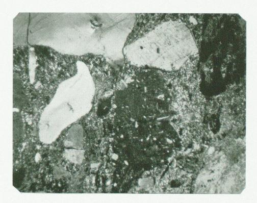
Photo nº 13. Pâte finement felsitique quartzo-feldspatique et séricitique, renfermant des esquilles de quartz, des fragments de feldspath potassique et des lamelles de biotite vert-brun. Echantillon Roffna nº 10.
