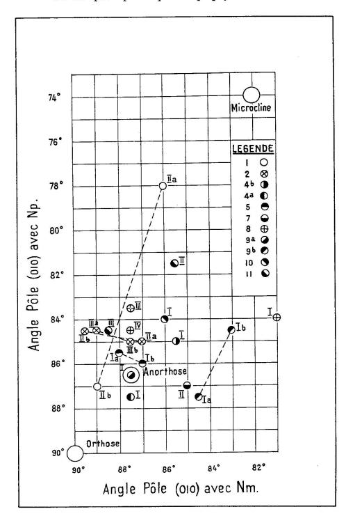
Fig. 6. Position des pôles de (010) par rapport aux axes principaux Nm et Np. Les pôles réunis par une ligne ponctuée correspondent à deux régions optiquement distinctes d'un même cristal.
