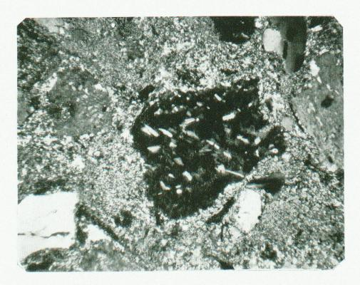
Photo nº 4. Pâte quartzo-feldspathique séricitique cimentant des fragments de quartz et de feldspath potassique à inclusions microlitiques d'albite. Echantillon Roffna nº 2.
