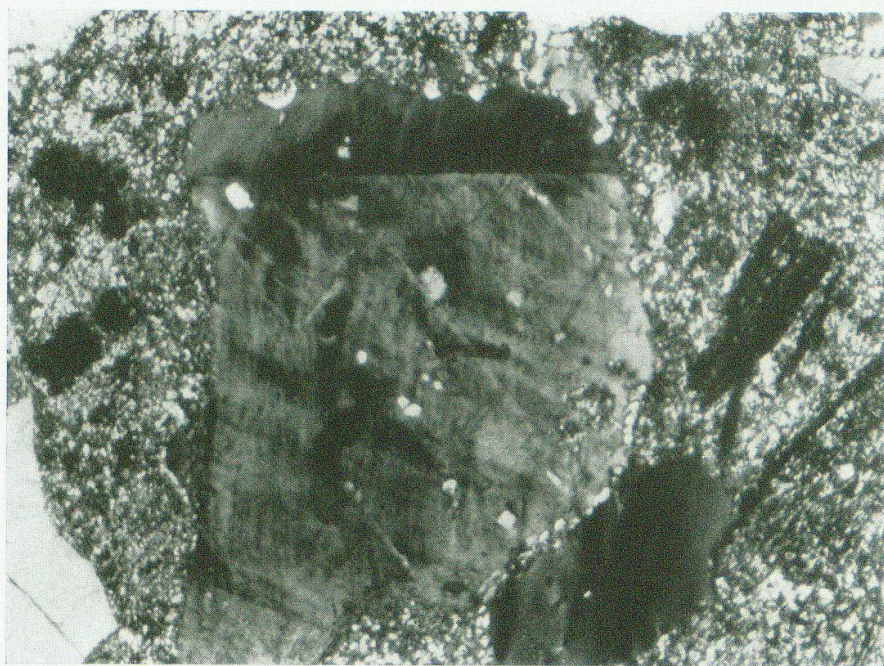
Photo n° 12. Plage de feldspath potassique maclé selon Baveno, à lamelles maclées floues selon la péricline. Echantillon Roffna n° 8.
